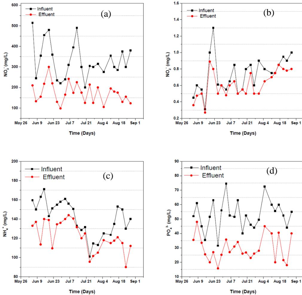
**Figure 16: The variation of (a) NO<sub>3</sub><sup>-</sup> (b) NO<sub>2</sub><sup>-</sup> (c) NH<sub>4</sub><sup>+</sup> (d) PO<sub>4</sub><sup>3-</sup> pollutants with time in HSSFCW at the influent and effluent**
